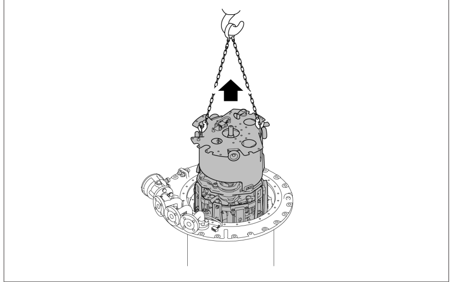
Resim 64: Yük değiştirme elemanının dışarı çıkarılması
