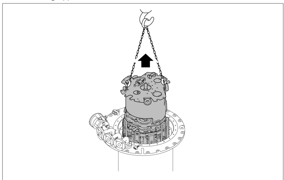
Figura 152: sollevamento del gruppo interruttore estraibile
