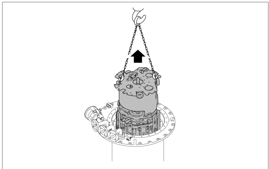
Figura 58: sollevamento del gruppo interruttore estraibile
