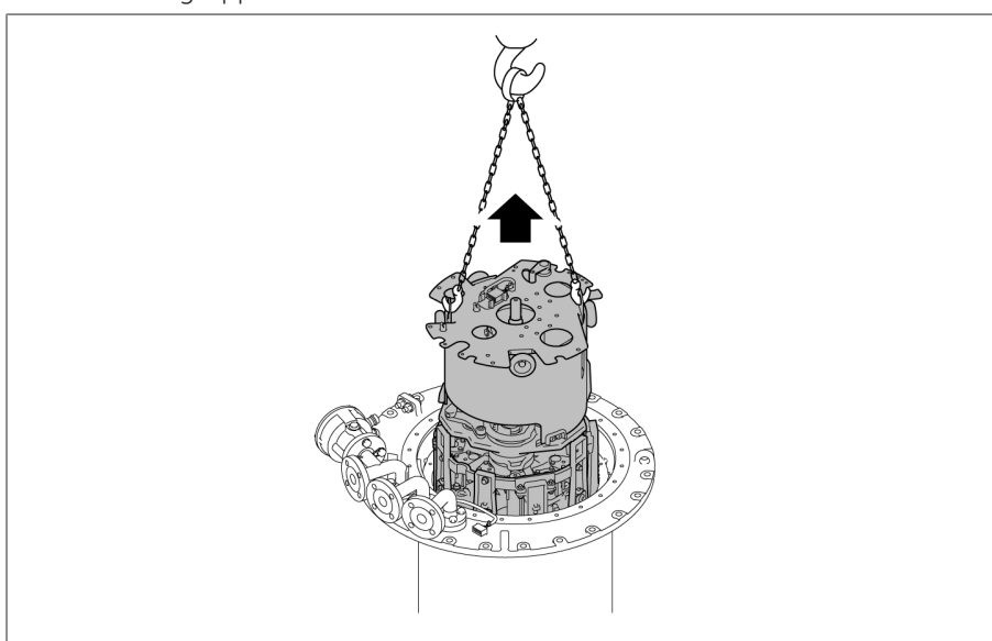
Figura 116: sollevamento del gruppo interruttore estraibile
